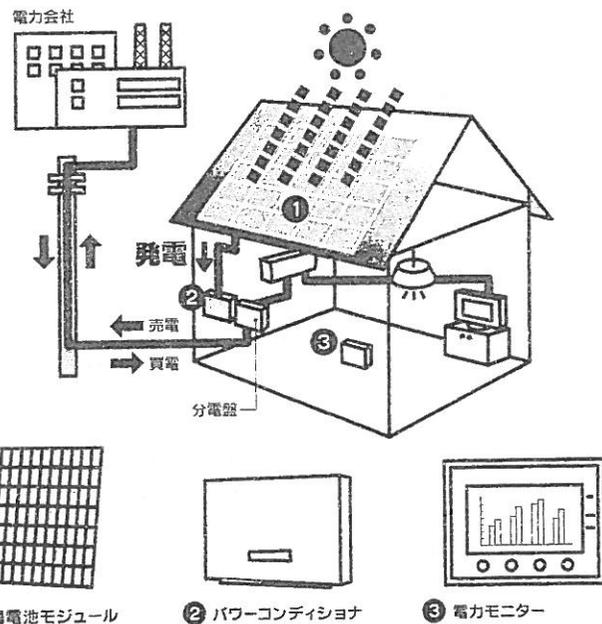
①太陽電池モジュール 屋根に設置し、太陽の光を集めるパネルです。
